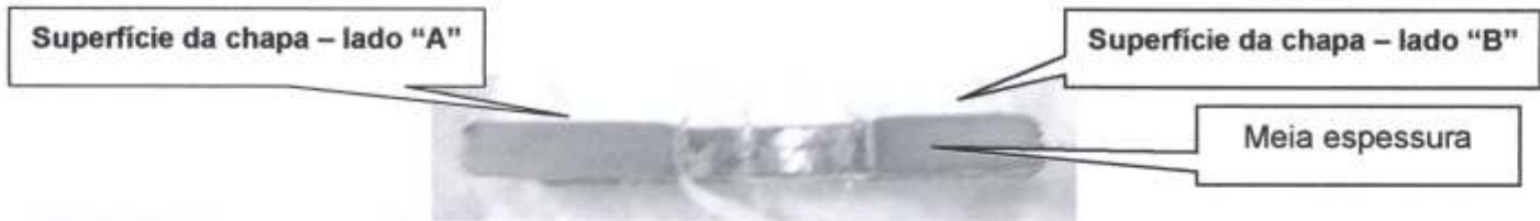
Fotografia 6 – Amostra S-40790 – Chapa Bonier - Local da análise metalográfica - Indicação dos pontos de medição de dureza.
