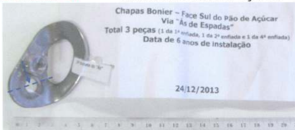
Fotografia 3 – Amostra S-40790 – CHAPELETA BONIER - Como recebida para realização dos ensaios propostos. Em azul local de remoção da amostra para realização da análise metalográfica. Escala em milímetros.
