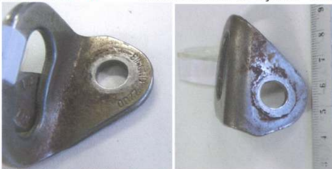
Fotografia 10 – Amostra S-40789 – Chapa SIMOND – detalhe da fotografia 09 - Observa-se produto de corrosão (vermelho), sendo este o ponto com corrosão na união entre o parafuso de fixação e a chapeleta.
