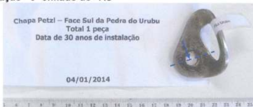
Fotografia 1 – Amostra S-40788 – CHAPELETA PETZL - Como recebida para realização dos ensaios propostos. Em azul local de remoção da amostra para realização da análise metalográfica. Escala em milímetros.
