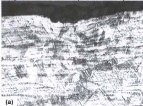
Micrografia 5: S-40790 – Chapa Bonier - Próximo à superfície com corrosão - Detalhe da micrografia 4 - (a) Material com microestrutura altamente encruada, indicativo de material obtido por deformação a frio. 400X; (b) Detalhe da região vista em (a). Ataque Marble, aumento 800X. Presença de corrosão na superfície da chapa.
