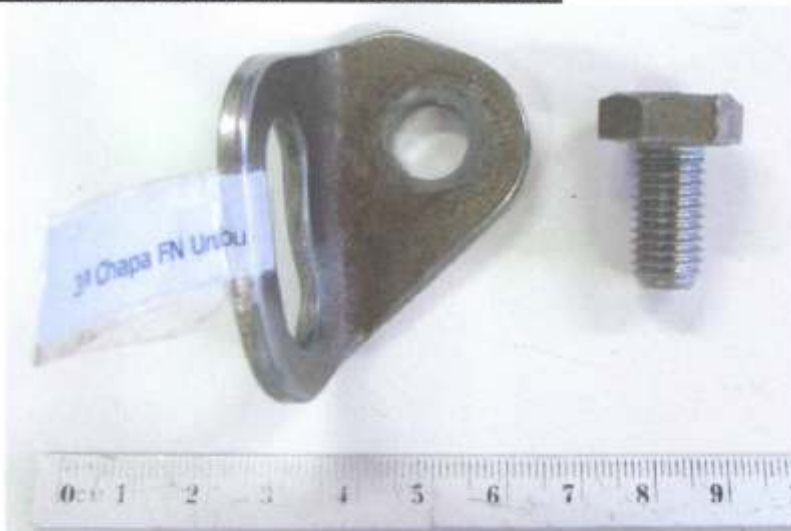
Fotografia 9 – Amostra S-40789 – Chapa SIMOND - Observa-se produto de corrosão (vermelho), na região de fixação da chapeleta na rocha pelo uso de parafuso.
