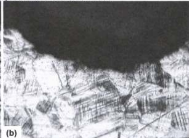
Micrografia 5: S-40788 – Chapa PETZL - Próximo à superfície com corrosão - Detalhe da micrografia 4 - (a) Material com microestrutura altamente encruada, indicativo de material obtido por deformação a frio. 400X; (b) Detalhe da região vista em (a). Ataque Vilella, aumento 800X.
