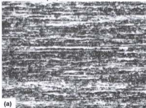
Micrografia 2: S-40789 – Chapa Simond - metal de base - (a) Microestrutura típica de material trabalhado a frio. A direcionalidade da matriz austenítica é mostrada pelas linhas retas horizontais, atacadas em função da resistência à corrosão do material estar reduzida. Aumento 100X; (b) Detalhe da região vista em (a). Ataque Marble, aumento 400X.
