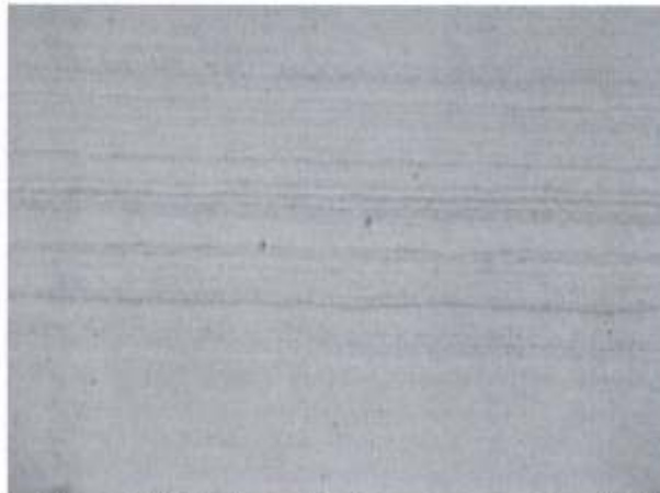
Micrografia 1: S-40788 – Chapa PETZL – Meia espessura - Distribuição de inclusões não-metálicas de óxidos globulares, série fina, tipo D e nível 1, conforme norma NBR NM 88/2000. Amostra sem ataque, 100X.
