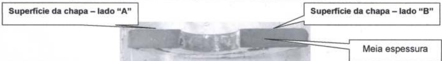
Fotografia 5 – Amostra S-40789 – Chapa Simond - Local da análise metalográfica - Indicação dos pontos de medição de dureza.
