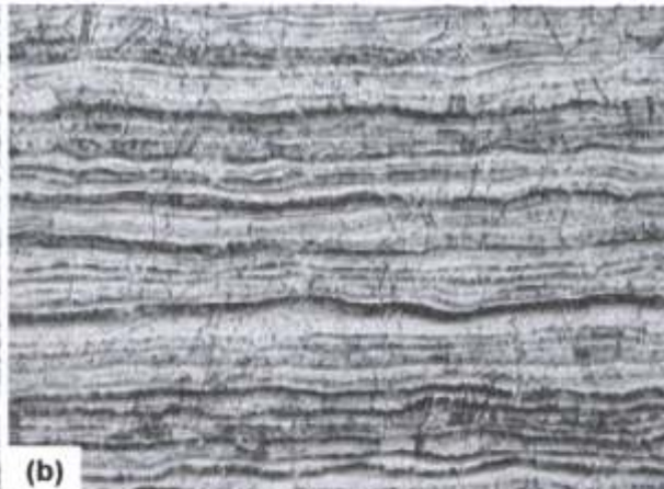
Micrografia 2: S-40788 – Chapa PETZL - metal de base - (a) Microestrutura típica de material trabalhado a frio. A direcionalidade da matriz austenítica é mostrada pelas linhas retas horizontais, atacadas em função da resistência à corrosão do material estar reduzida. Aumento 100X; (b) Detalhe da região vista em (a). Ataque Vilella, aumento 400X.
