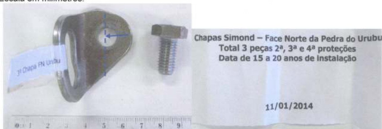
Fotografia 2 – Amostra S-40789 – CHAPELETA SIMOND - Como recebida para realização dos ensaios propostos. Em azul local de remoção da amostra para realização da análise metalográfica. Escala em milímetros.
