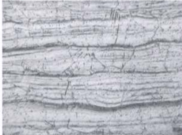
Micrografia 3: S-40788 – Chapa PETZL -metal de base - Detalhe da região vista em 2a. Presença de precipitação de carbeto. Ataque Vilella, aumento 800X
