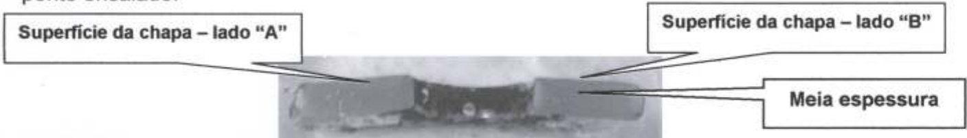
Fotografia 4 – Amostra S-40788 – Chapa PETZL - Local da análise metalográfica - Indicação dos pontos de medição de dureza.
