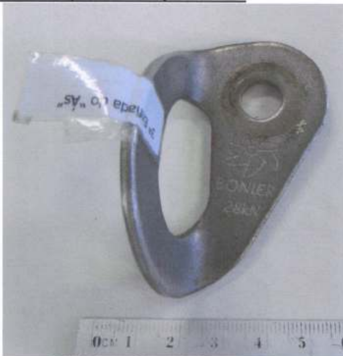
Fotografia 11 – Amostra S-40790 – Chapa BONIER - Observa-se produto de corrosão (vermelho), na região de fixação da chapeleta na rocha pelo uso de parafuso.
