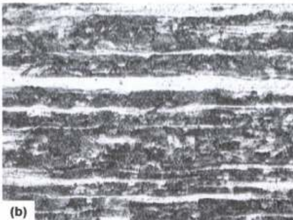
Micrografia 2: S-40789 – Chapa Simond - metal de base - (a) Microestrutura típica de material trabalhado a frio. A direcionalidade da matriz austenítica é mostrada pelas linhas retas horizontais, atacadas em função da resistência à corrosão do material estar reduzida. Aumento 100X; (b) Detalhe da região vista em (a). Ataque Marble, aumento 400X.
