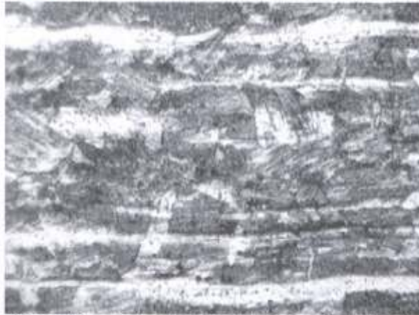
Micrografia 3: S-40789 – Chapa Simond - metal de base - Detalhe da região vista em 2a. Ataque Marble, aumento 800X
