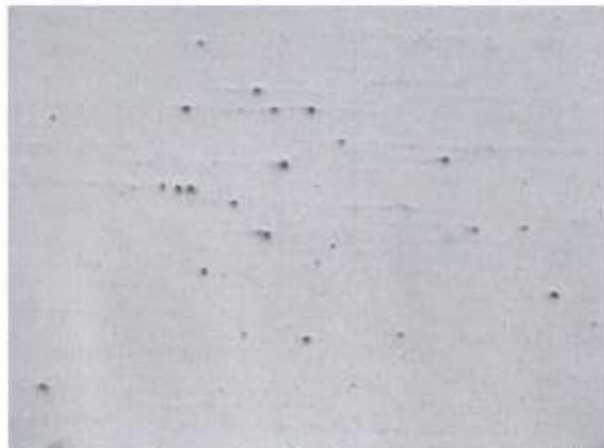
Micrografia 1: S-40789 – Chapa Simond – Meia espessura - Distribuição de inclusões não-metálicas de óxidos globulares, série fina, tipo D e nível 3, conforme norma NBR NM 88/2000. Amostra sem ataque, 100X.
