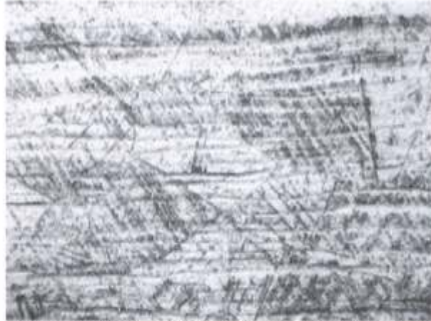
Micrografia 3: S-40790 – Chapa Bonier -metal de base - Detalhe da região vista em 2a. Presença de precipitação de carbeto. Ataque Marble, aumento 800X.
