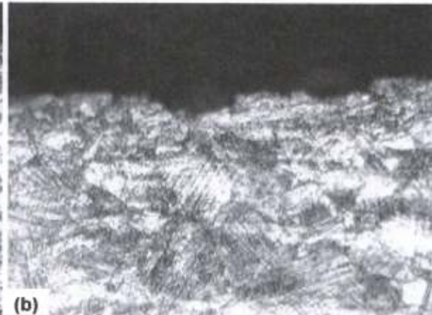
Micrografia 5: S-40789 – Chapa Simond - Próximo à superfície com corrosão - Detalhe da micrografia 4 - (a) Material com microestrutura encruada, indicativo de material obtido por deformação a frio. 400X; (b) Detalhe da região vista em (a). Ataque Marble, aumento 800X.
