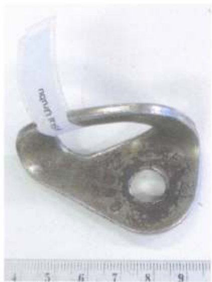
Fotografia 7 – Amostra S-40788 – Chapa PETZL - Observa-se produto de corrosão (preto), na região de fixação da chapeleta na rocha pelo uso de parafuso.
